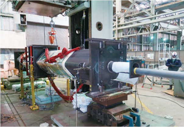
低温実大曲げ試験試験状況
